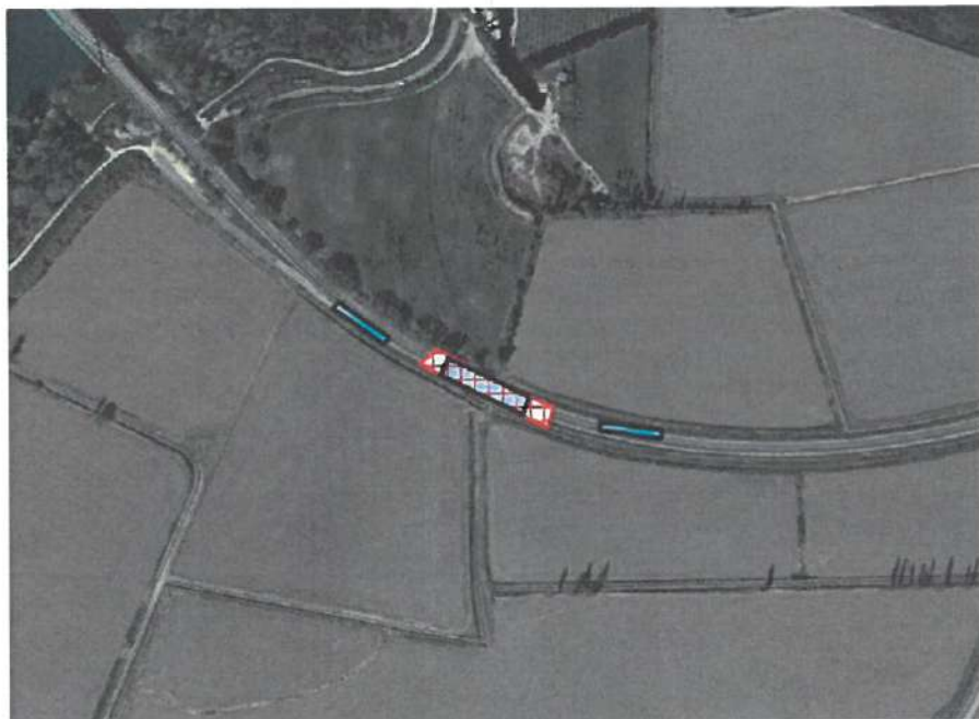
Zoom sur le tronçon 2 : localisation du secteur de franchissement routier par les chiroptères (hachuré en orange), de l'emplacement sur la chaussée des bandes de 20 mètres - revêtement BBTM-06 (bleu diffus) et des autres matériaux (revêtement ECF-06) sur le secteur de passage des chiroptères
