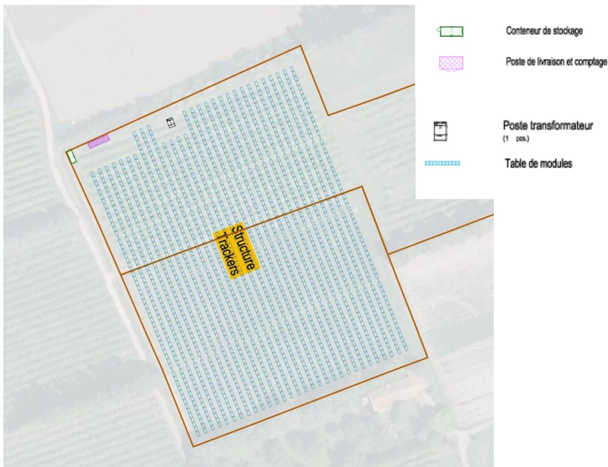
Figure 11 : plan d'implantation du projet agrivoltaïque envisagé sur la zone 2 (source : BayWa r.e.)
