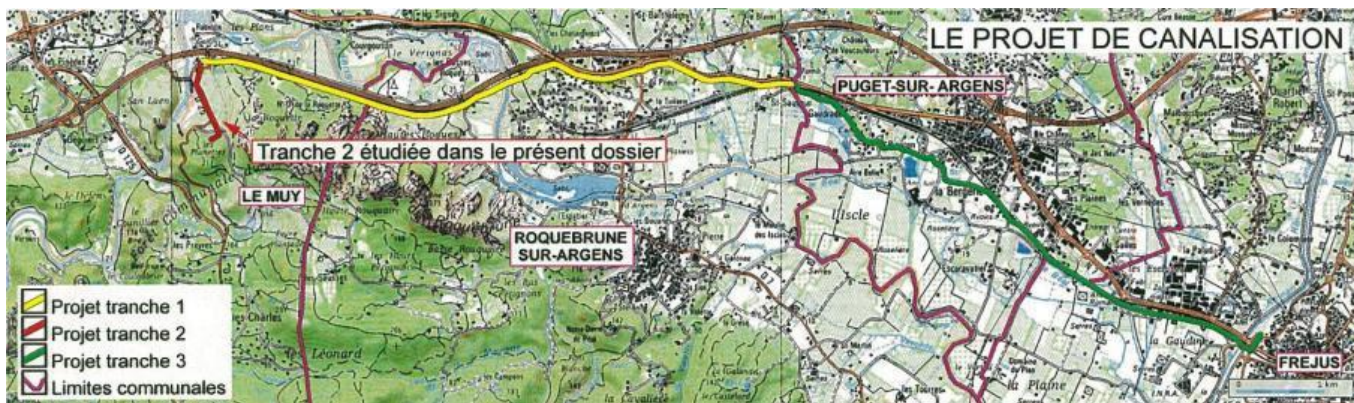
Image 1 : Projet de renouvellement de la canalisation d'eau potable entre Le Muy et Fréjus (Source: Cabinet Merlin)
