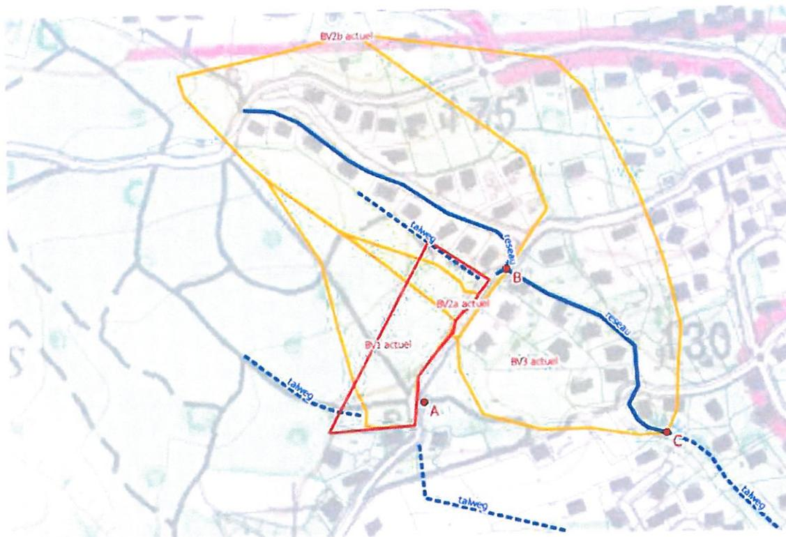
Bassins versants et situation actuelle des axes d'écoulement – extrait de la notice hydraulique –
