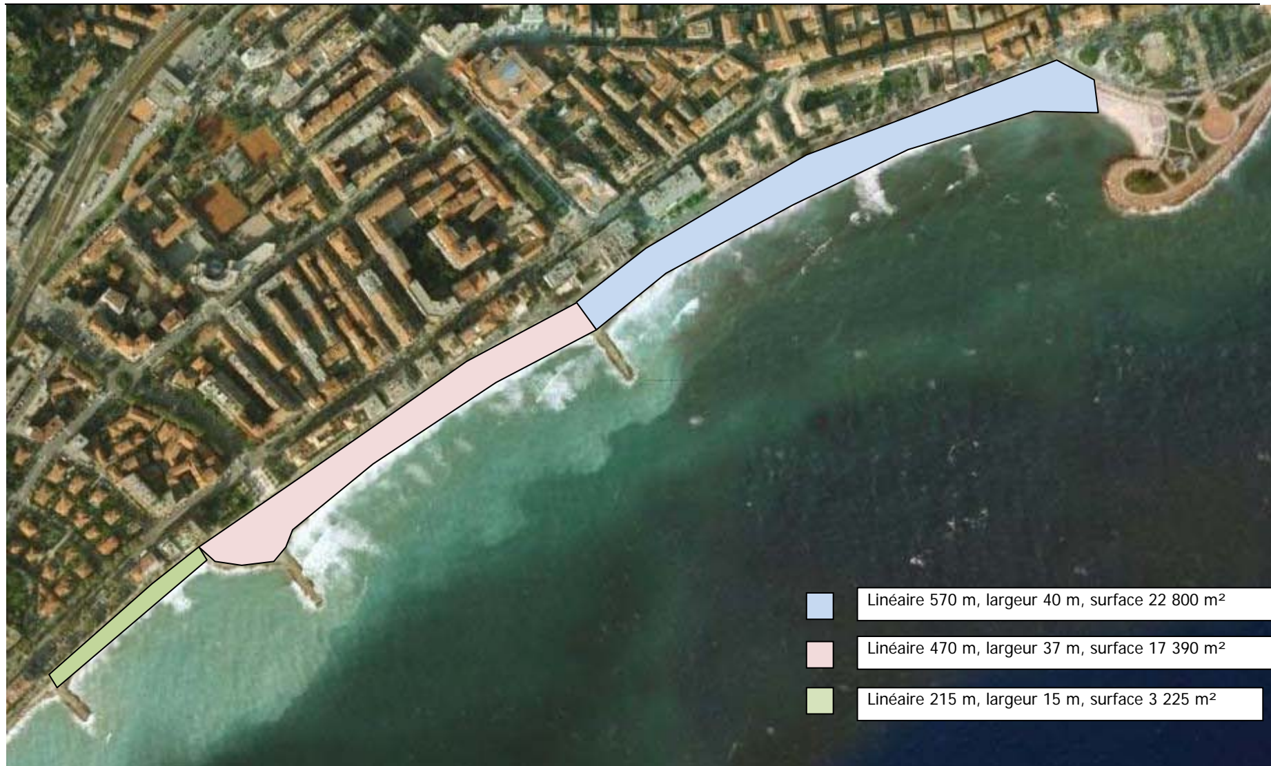
Figure 9: Plan représentant les surfaces préconisées pour le rechargement des plages. Les dimensions sont données à titre indicatif et représentent les moyennes des mesures faites.
