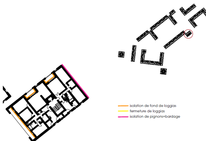
Exemple 2 : Modalités d'isolation des différents étages de la Barre J
