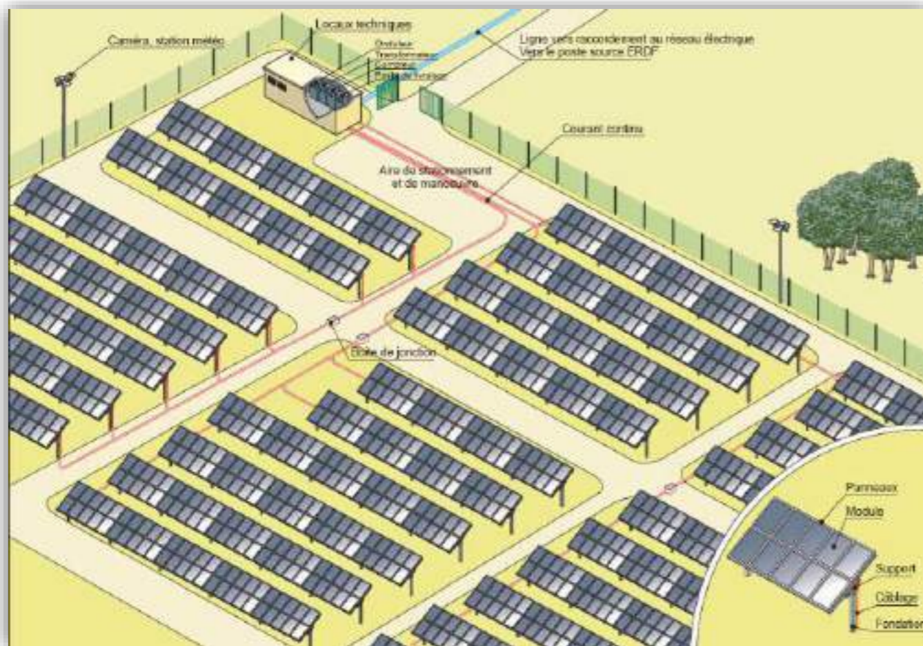
Principe d'implantation d'une centrale solaire
