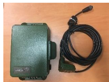
Figure 12 : Enregistreur SM4Bat avec microphone U2
