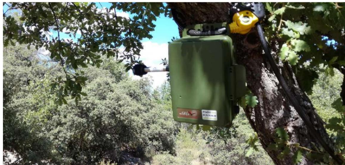
Figure 4 : Pose de SM4Bat pour les inventaires acoustiques au sol (Source : Y. RONCHARD)
