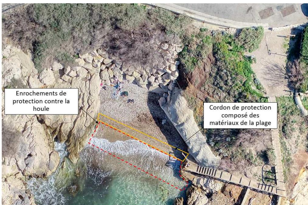
*Représentation schématique de l'ouvrage de protection provisoire – DSA03*
