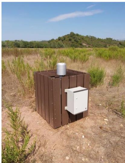
Illustration 21 : Pluviomètre enregistreur installé sur le dépôt du Lenté - Fonsante - Tanneron (83).
