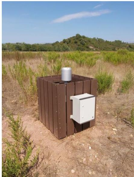
Illustration 20 - Pluviomètre enregistreur installé sur le dépôt du Lenté - Fonsante - Tanneron (83).
