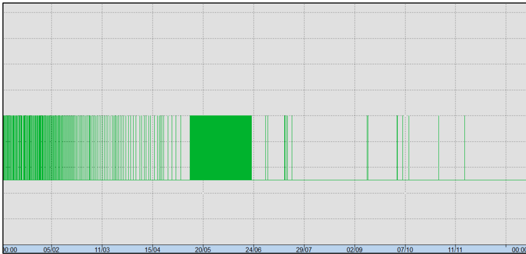
Illustration 9 - Station de relevage des Sauvaires - Diagramme 2020 de fonctionnement de la pompe - Commune de Gardanne (13).
