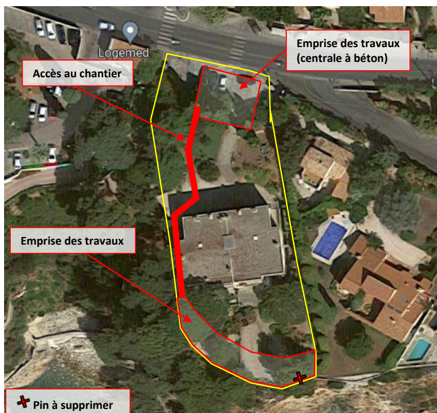
Figure 61 : Installation schématique des emprises de chantier
