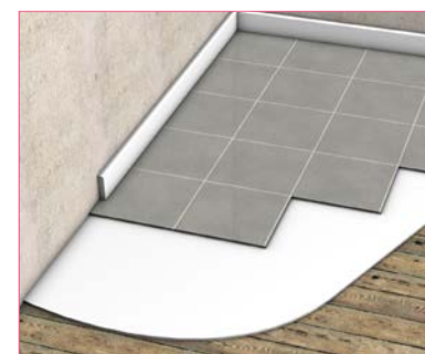
Pose d'un revêtement de sol dur
