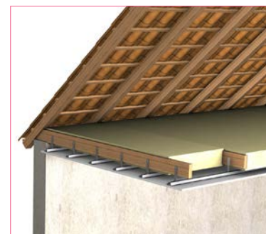
Isolation thermique intérieure du plancher sous combles perdus
