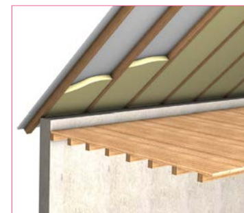
Isolant en sous face de la couverture
