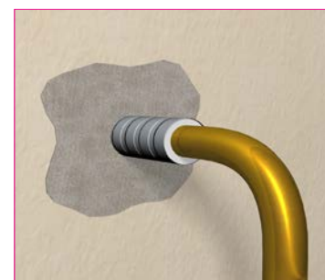
Colmatage sur gaine et joint
