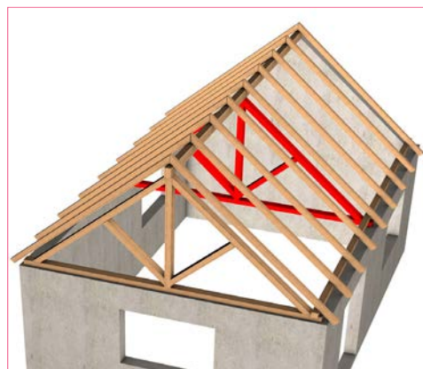
Charpente traditionnelle : Ajout d'une ferme
