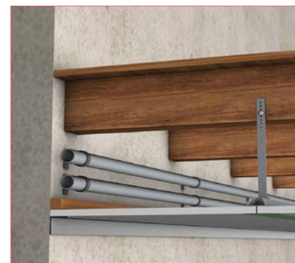
Plafond avec plenum
