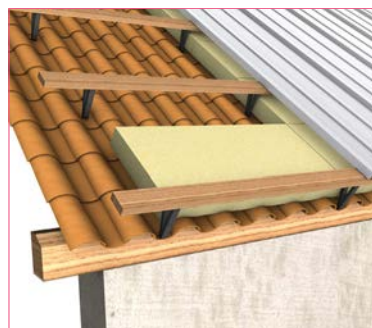
Isolation extérieure par sur-couverture
