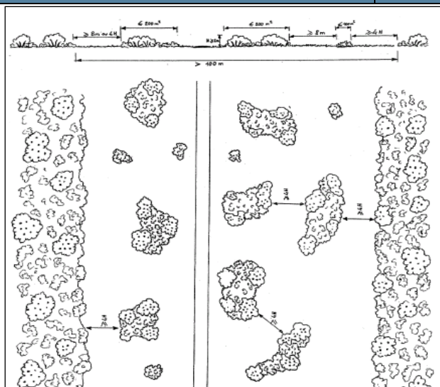
Illustration du traitement de la strate arbustive par le débroussaillage alvéolaire
