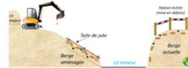
Etape 5/6 : Exemple 1 : Aménagement avec géotextile en fibre végétale et ré-étalement des terres favorables à la Consoude bulbeuse
