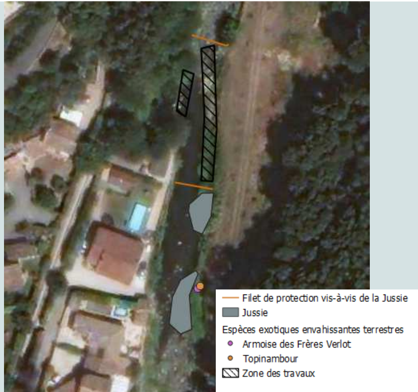
FIGURE 29 : LOCALISATION DES FILETS DE PROTECTION VIS-À-VIS DE LA JUSSIE
