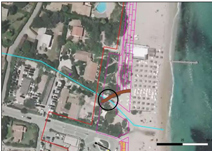
Vallat préservé grâce à l'aménagement d'une structure surélevée - secteur Patch
