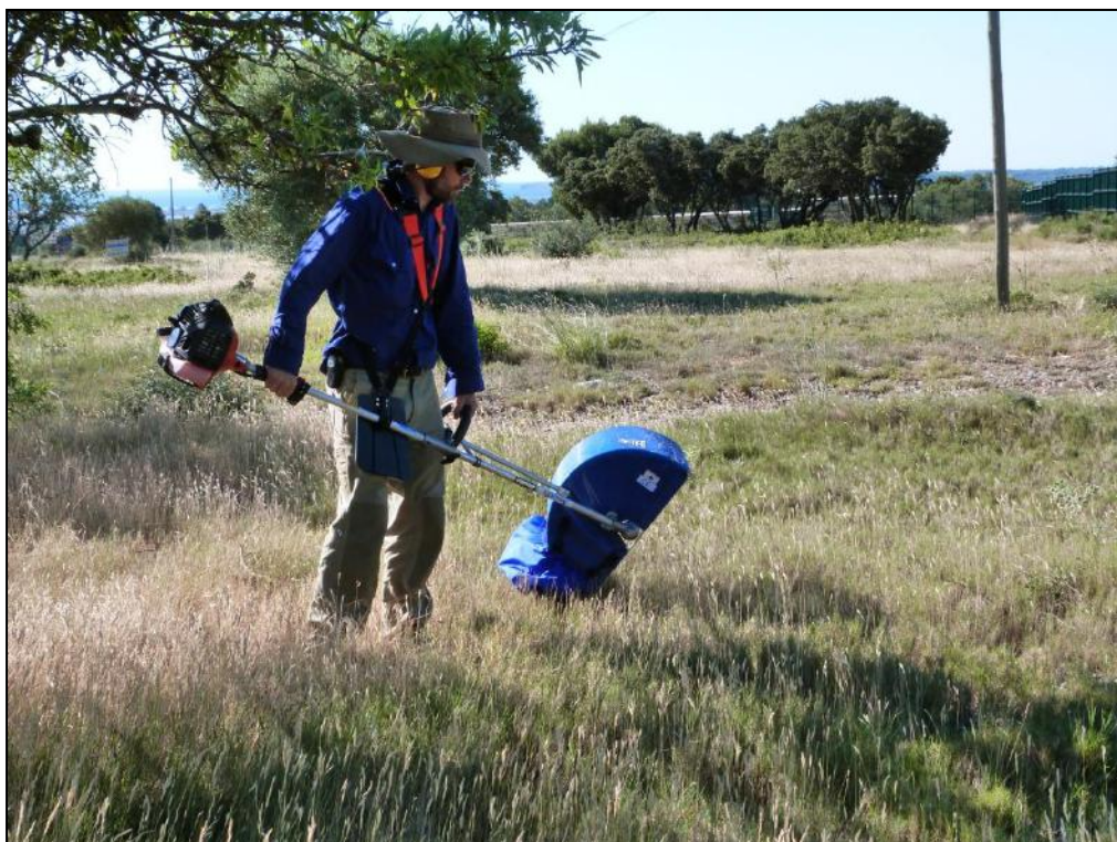
Utilisation de la moissonneuse portable pour récolter les semences d'une pelouse sèche dans les Corbières (11)
