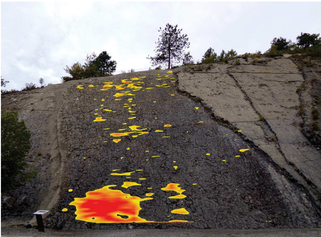
Cartographie des cavités derrière la Dalle à ammonites entre 10 et 40 cm.
