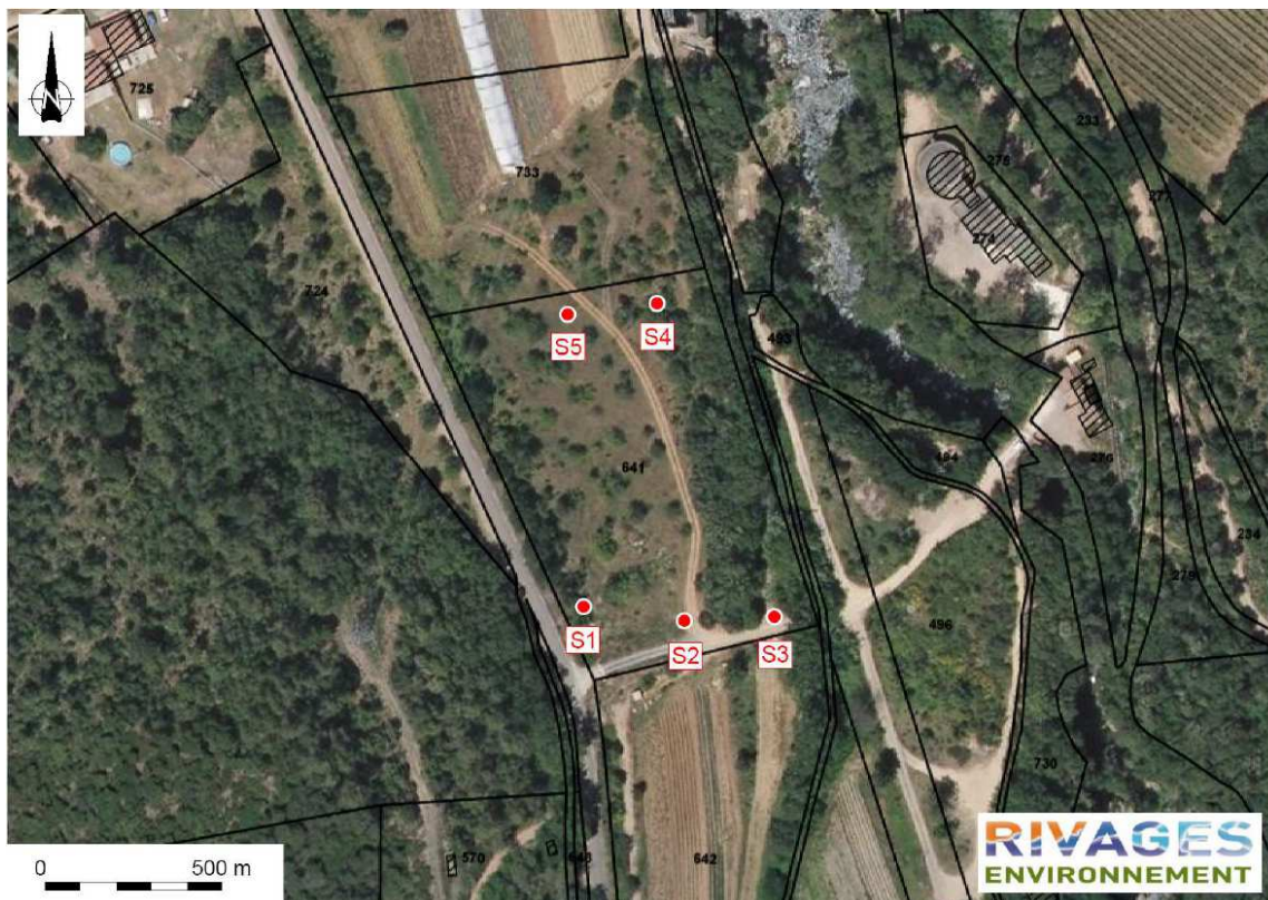
Figure 1 : Localisation des forages de reconnaissance (Source : Rivages Environnement)
