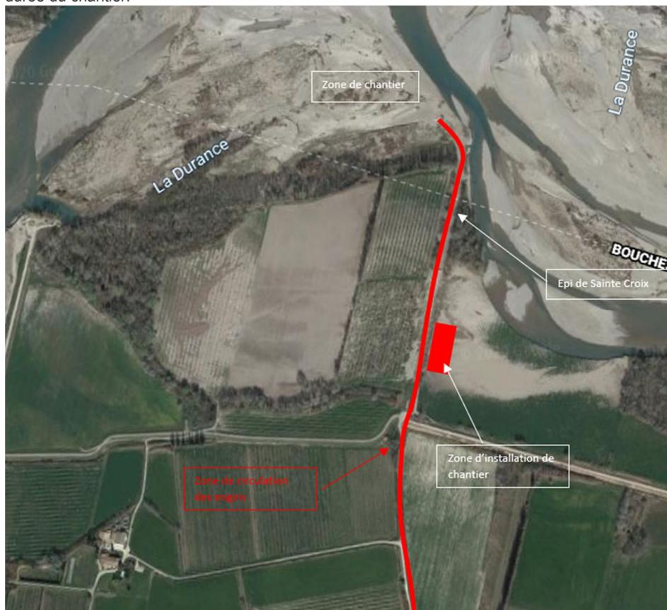
Plan d'accès au chantier et zone d'installation de chantier (site de Charleval)
