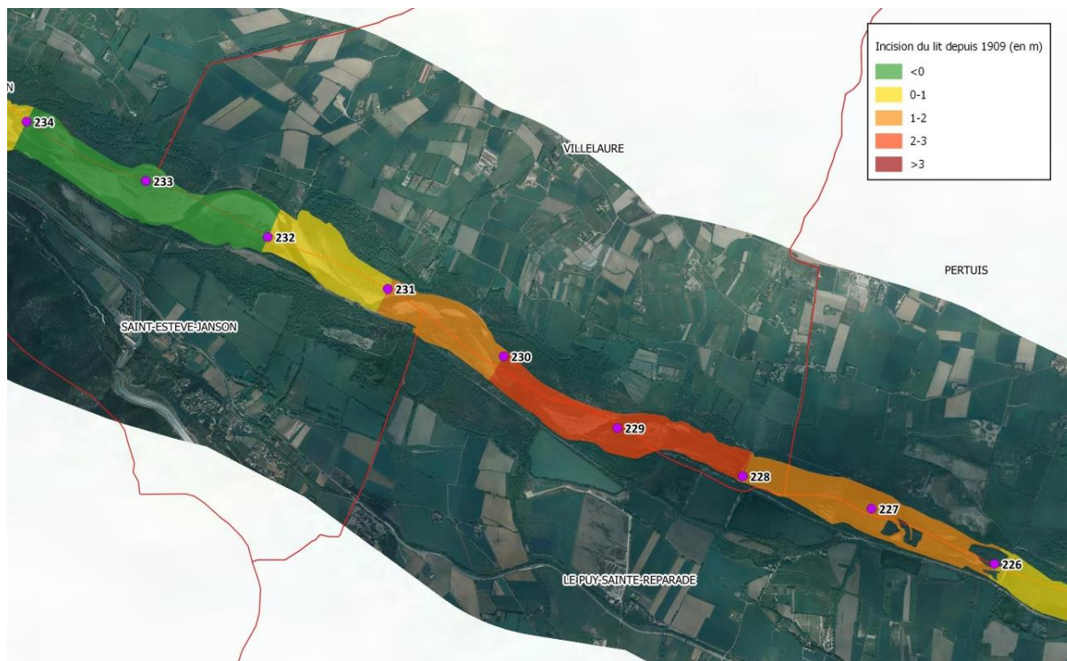
Figure 16 : Analyse de l’incision moyenne du lit (GFH comparé aux données extraites du LIDAR 2017) sur un kilomètre (référentiel des PK Durance).
