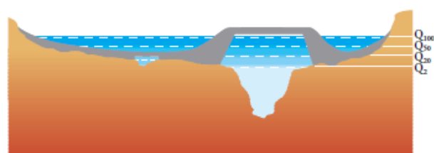
Partie 2 - Figure 22 : principe d'itinéraire submersible au-delà de Q50 – Source : D. Goutx (CETE Normandie-Centre - LRPC Blois)
