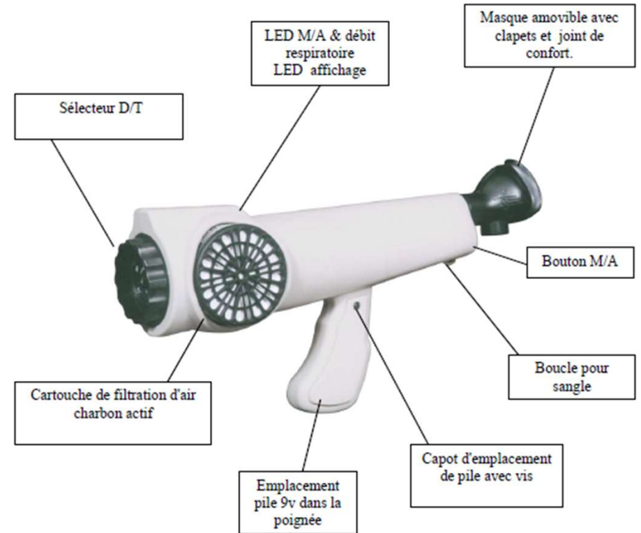
Olfactomètre de terrain (Nasal Ranger) Limite de quantification < 2 \text{ ou}_E/\text{m}^3
