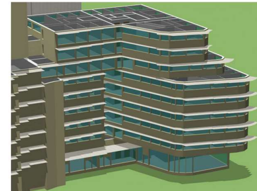
21 juin 12h00 : protection solaire par masques proches dans les bureaux et le restaurant au Sud
