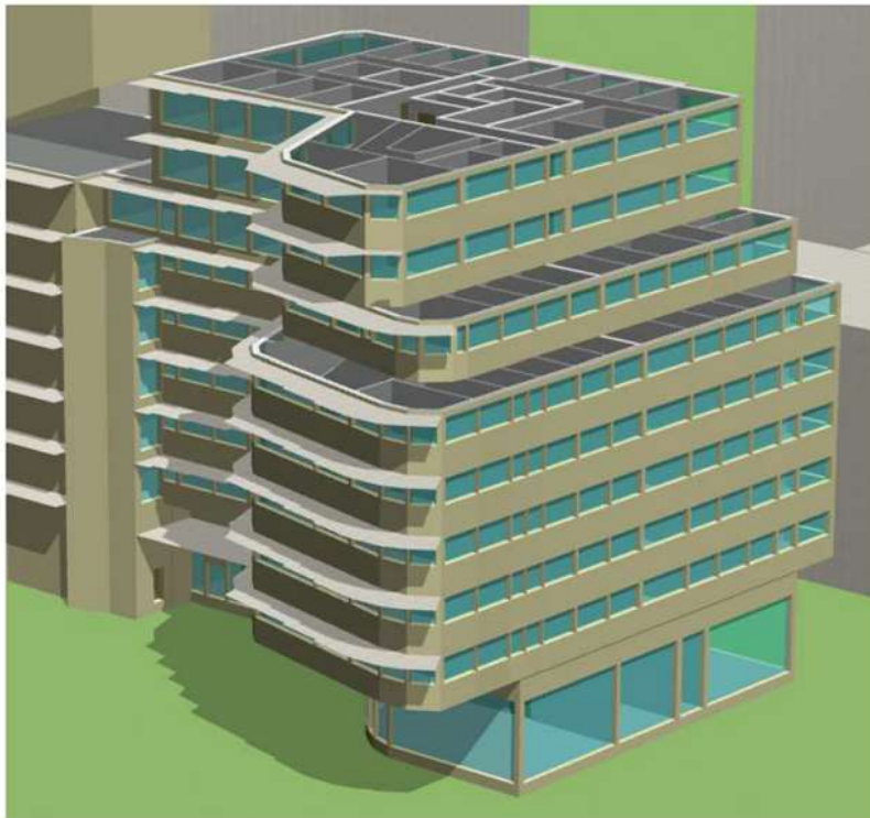
21 juin 9h00: nécessité de protection solaire dans les bureaux et le restaurant à l'Est
