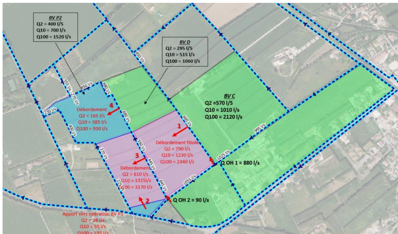
Illustration 21 : Synthèse du fonctionnement hydraulique en situation actuelle
