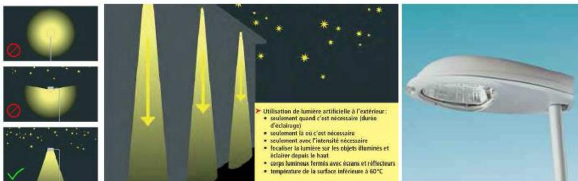
Figure 6 : Principes d'éclairage compatibles avec l'environnement naturel
