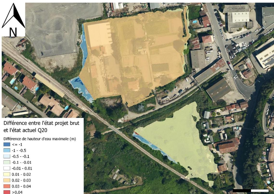
Figure 18 : Zoom sur les différences de hauteur d'eau maximale entre l'état projet brut (Figure 13) et l'état actuel du vallon Q20 (Figure 33)
