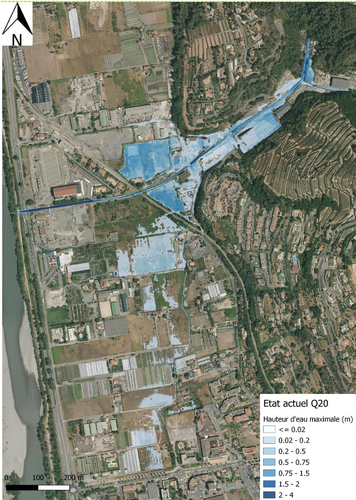
Figure 37 : Hauteur d'eau maximale pour Q20 à l'état actuel
