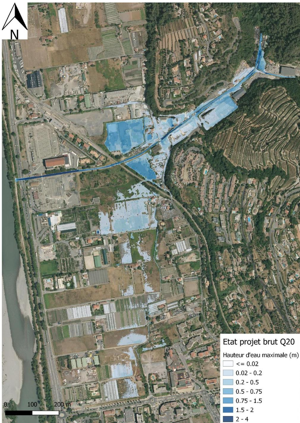
Figure 15 : Hauteur d'eau maximale état projet brut Q20
