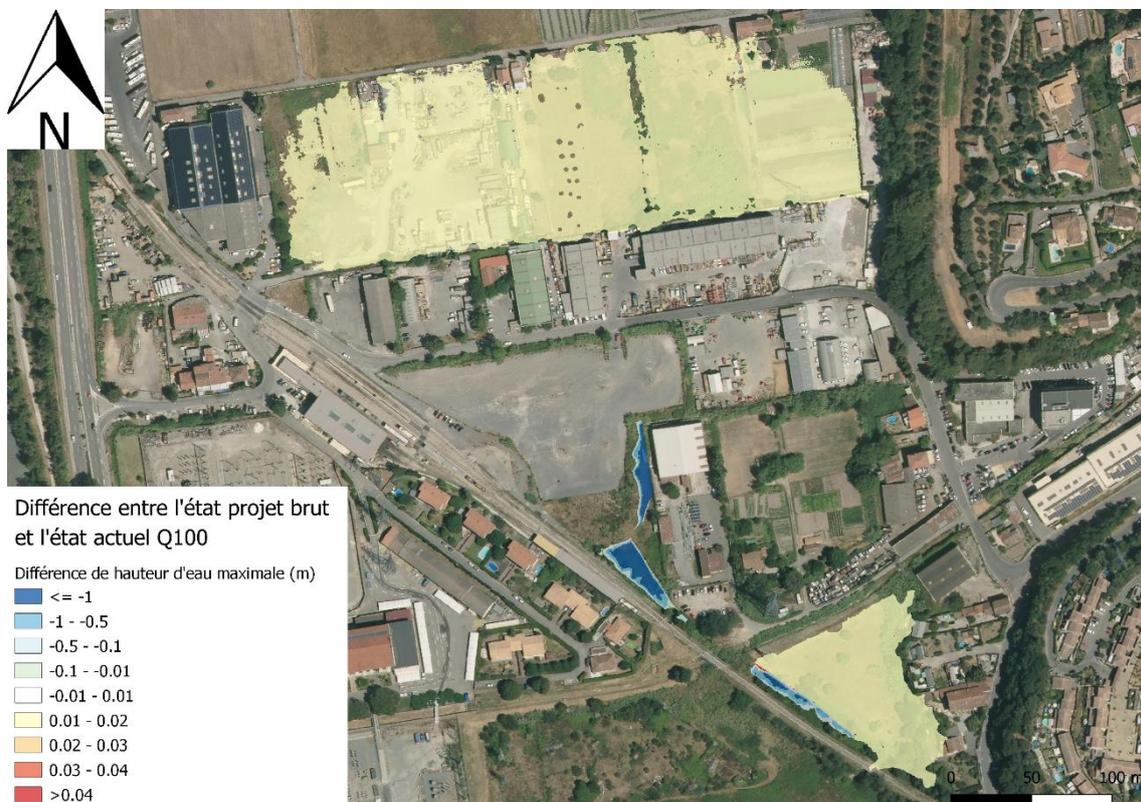
Figure 23 : Zoom sur les différences de hauteur d'eau maximale entre l'état projet brut (Figure 20) et l'état actuel du vallon Q100 (Figure 35)
