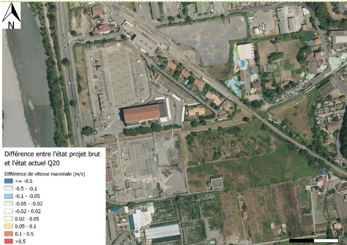
Figure 19 : Différence de vitesse maximale entre l'état projet brut (Figure 16) et l'état actuel du vallon Q20 (Figure 38)
