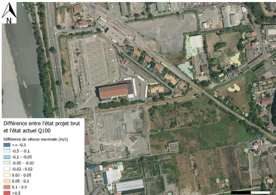
**Figure 24 : Différence de vitesse maximale entre l'état initial du projet (Figure 21) et l'état actuel du vallon Q100 (Figure 36)**
