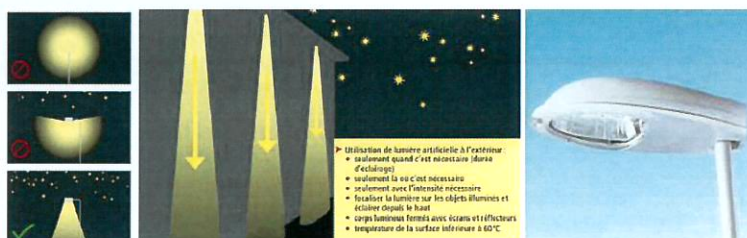
Figure 5 : Principes d'éclairage compatibles avec l'environnement naturel
