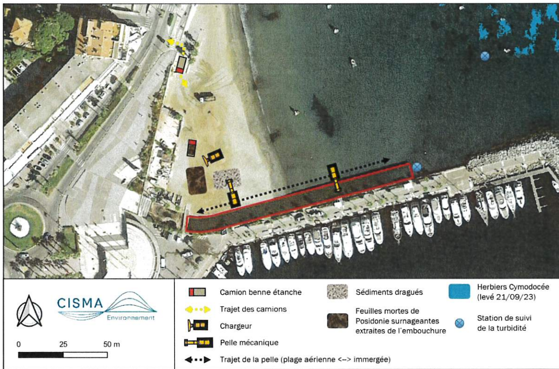
Figure 1 : Schéma de principe des opérations d'extraction des feuilles mortes de Posidonie et des sédiments dans l'embouchure de la Castillane
