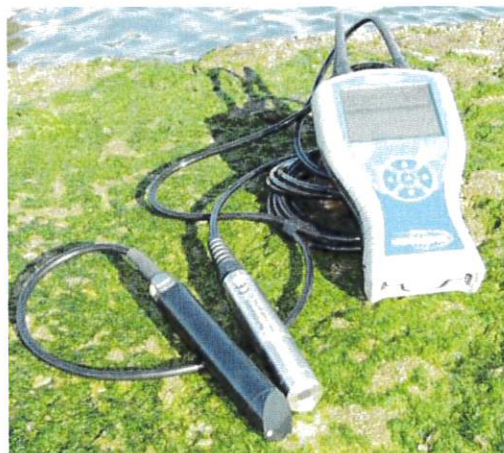
Figure 7 : Exemple de sonde turbidimètre pour mesures in situ de la turbidité de l'eau
