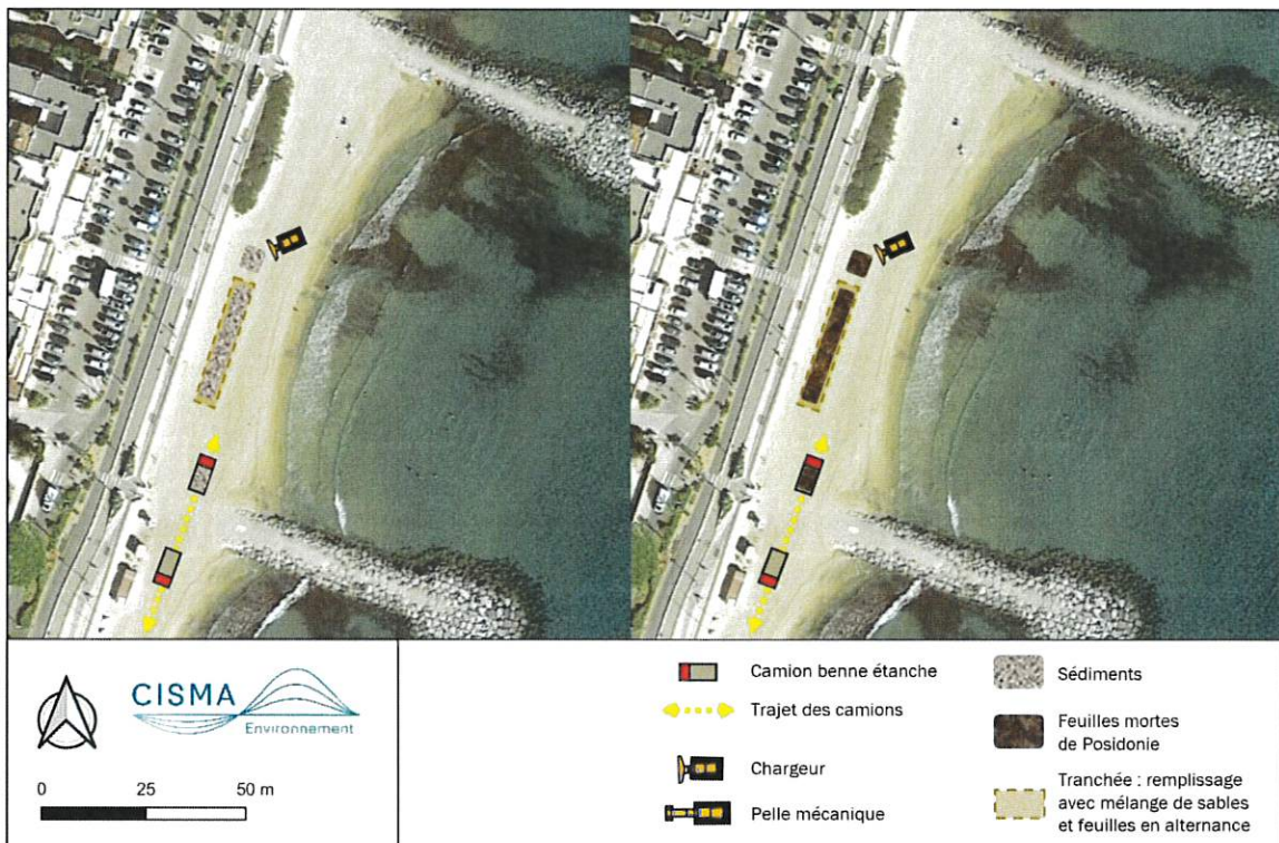
Figure 5 : Schéma de principe de l'enfouissement des feuilles et des sédiments selon la technique du « mille-feuille »
