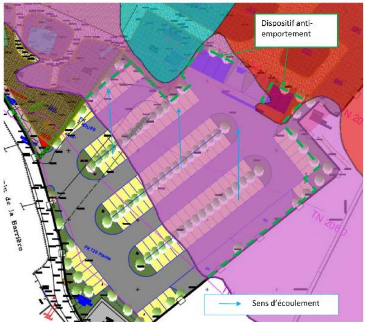
Périmètre d'installation du dispositif anti-empalement
