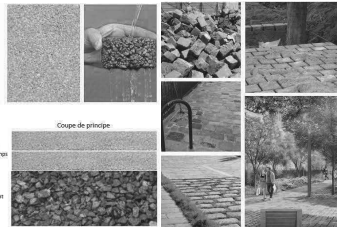
Figure 31 : principes de perméabilité des sols sur l'îlot des Fabriques (AVP - 2020)
