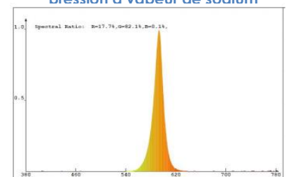
Courbe spectrophotométrique des ampoules Leds ambrées
