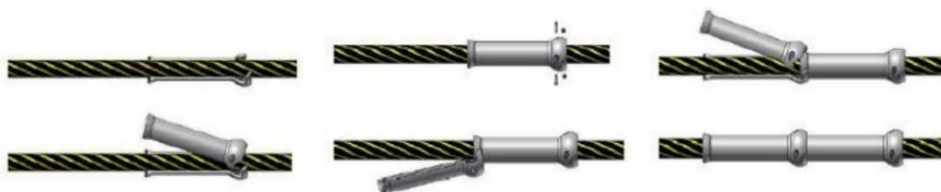
Figure 21 : Procédure d'installation des coques de protection sur le câble
