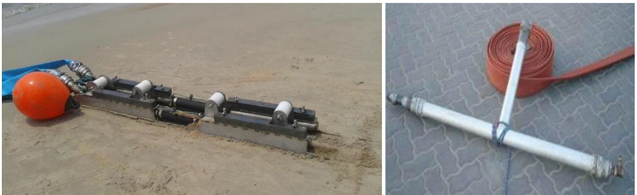
Figure 23 : « Jet sledge » de type WORM pour les eaux très peu profondes (à gauche), lance à eau d'ensouillage (à droite) (source : Orange Marine)
