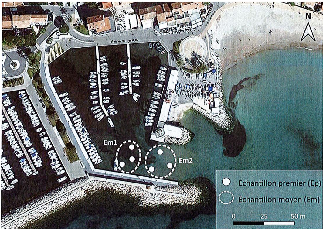
Figure 12 : Plan d'échantillonnage des sédiments à l'entrée du port
