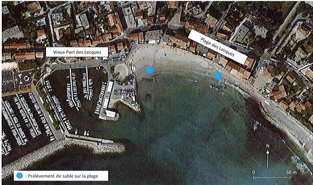
Figure 13 : Plan d'échantillonnage des sables sur la plage au Nord du port
