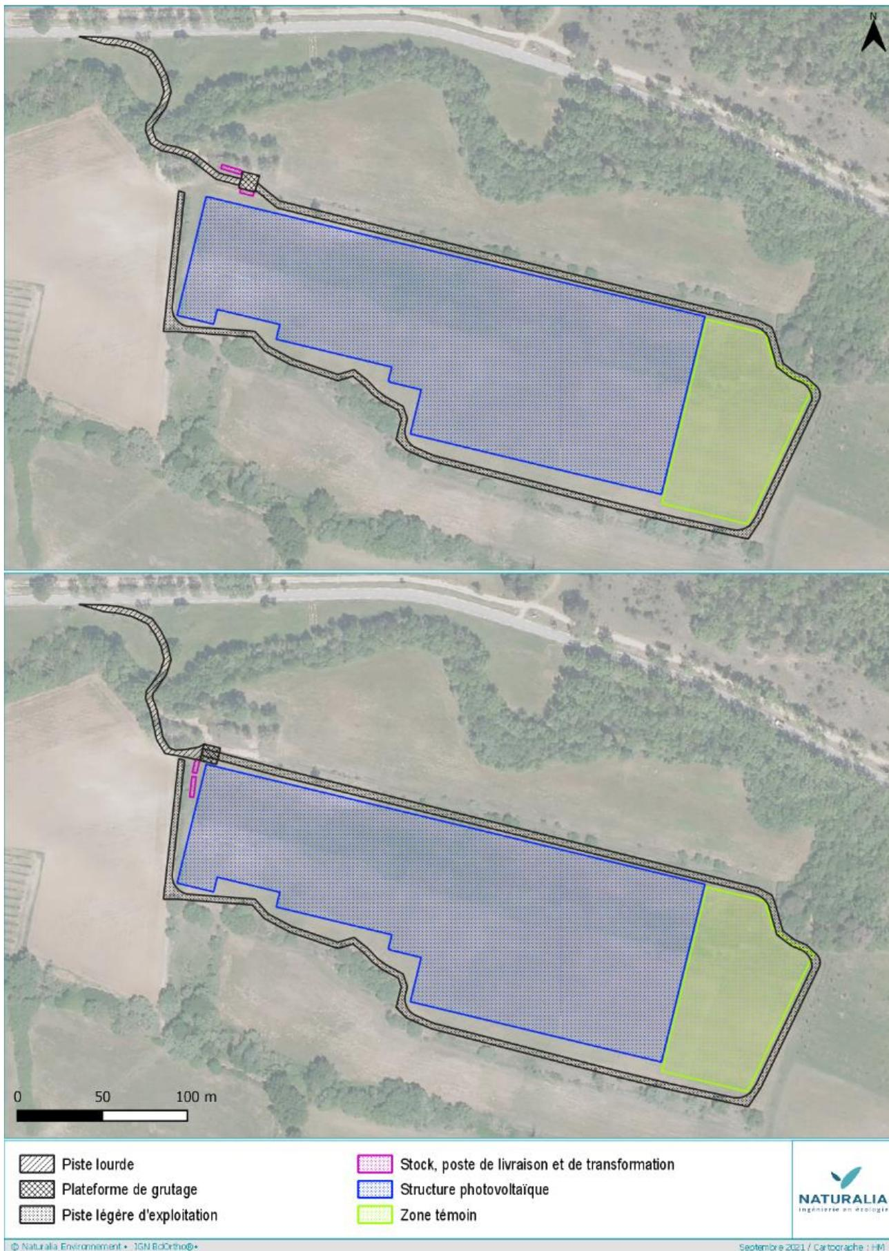
Figure 23. Comparaison des variantes au projet
