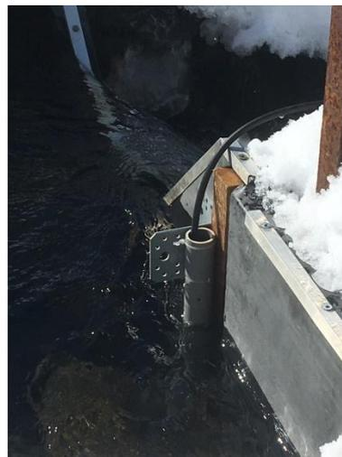
Figure 3 : sonde de mesure de hauteur
