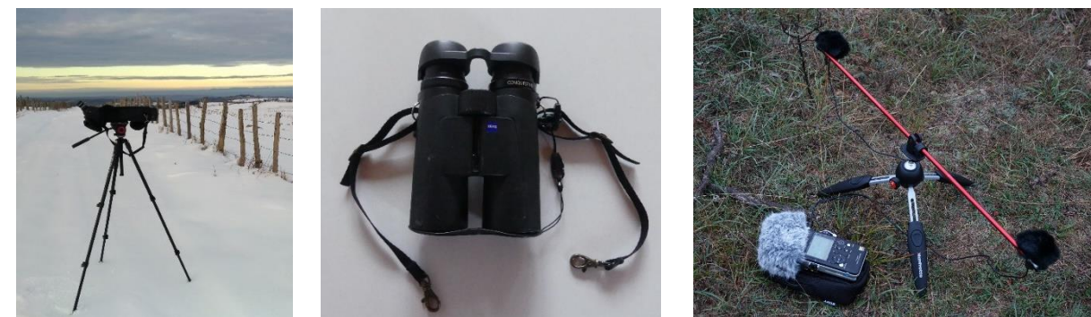
Longue vue (gauche), jumelles de terrain (centre) et Dispositifs expérimentaux d'enregistrement sonore des oiseaux nocturnes (un enregistreur relié à deux micros ; enregistrement en stéréo) (droite) Photos : ARTIFEX – 2018
