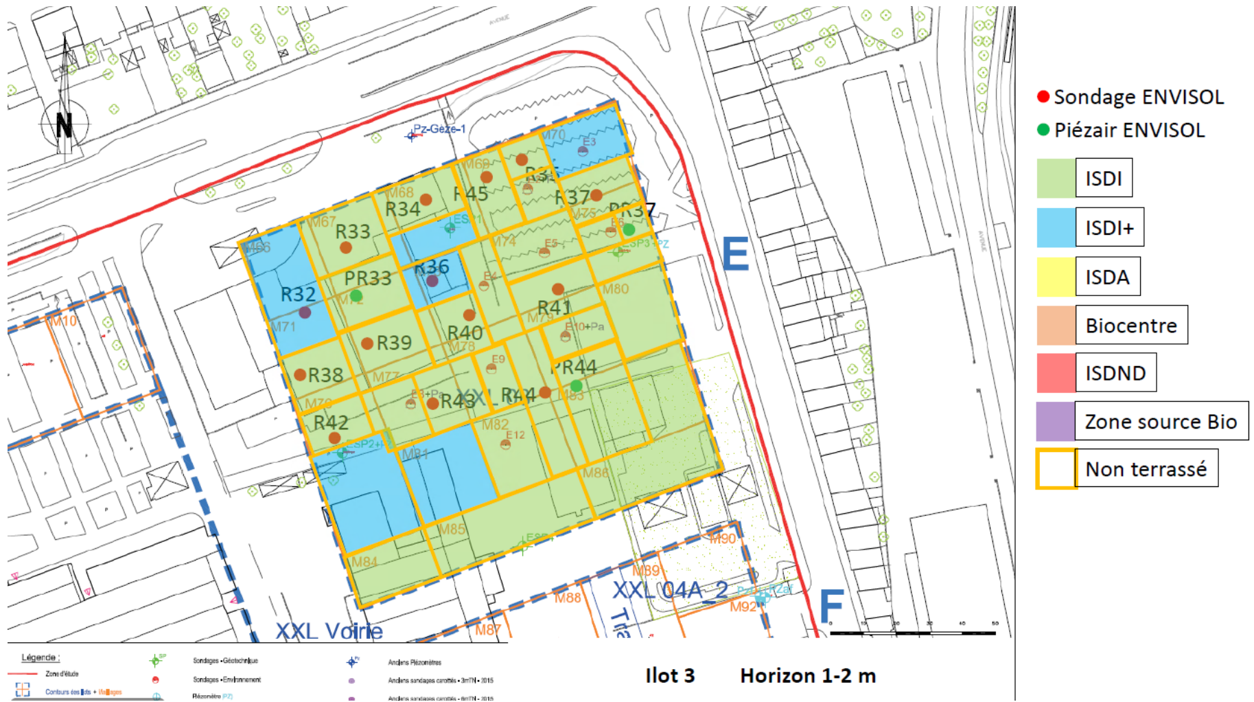
Figure 8. Plan de terrassement pour un niveau de sous-sol – Tranche de sol 1,0 – 2,0 m (Source : RESOLVE)
