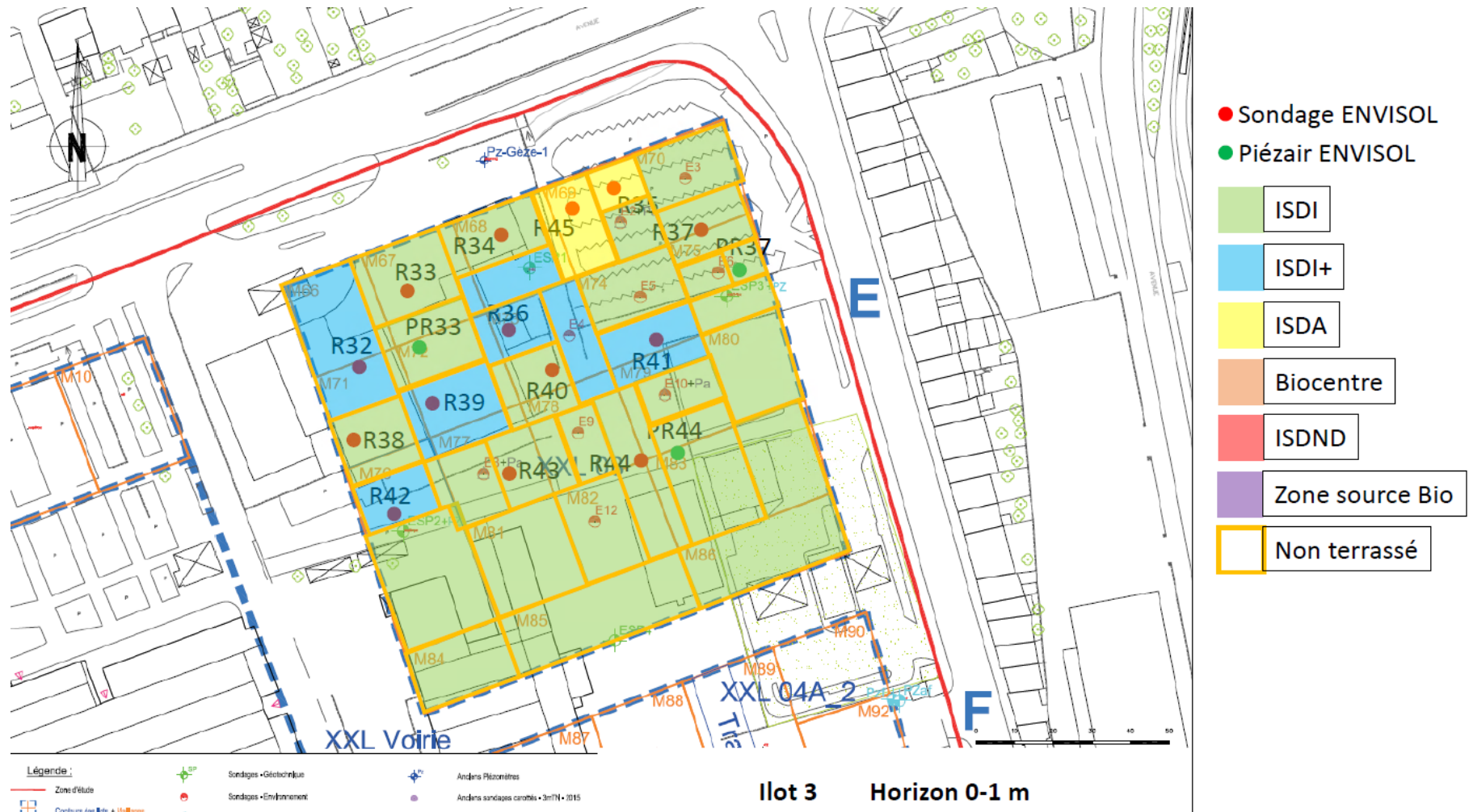
Figure 14. Plan de terrassement pour deux niveaux de sous-sol – Tranche de sol 0 – 1,0 m (Source : RESOLVE)
