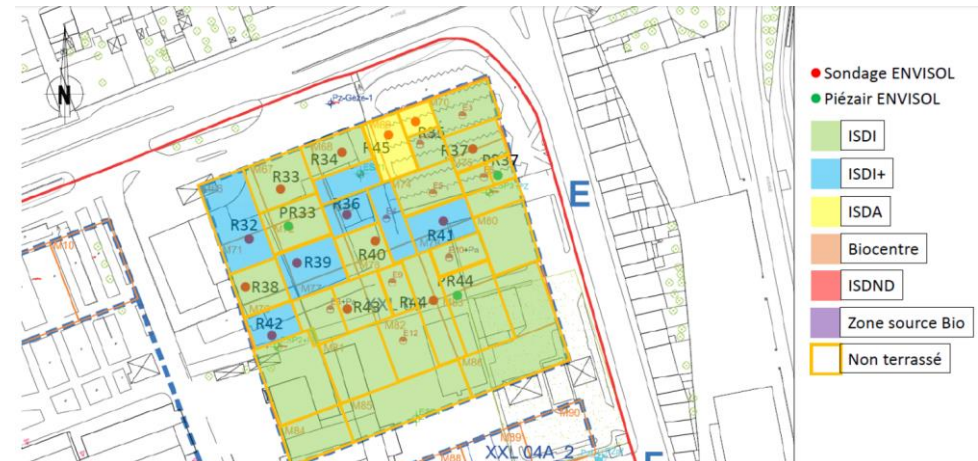
Figure 52 : Plan de terrassement pour un niveau de sous-sol – Tranche de sol 0 – 1,0 m (Source : RESOLVE)
