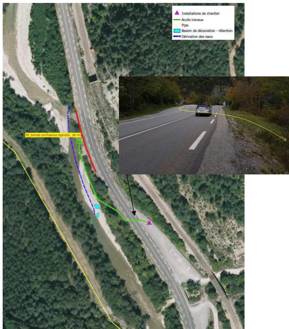
Figure 23 : installation de chantier et accès au site 9
