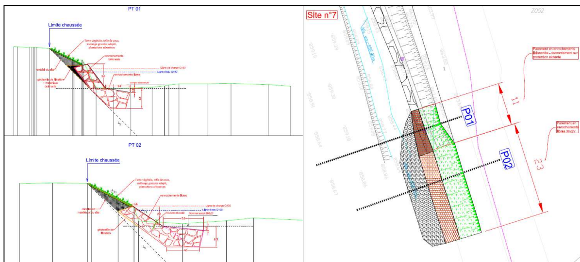
Figure 15: coupe de confortement – site 7
