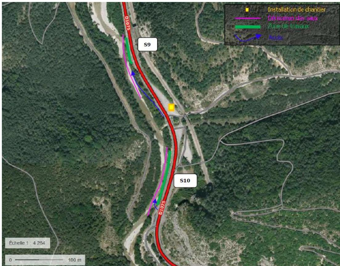
Figure 8 : Délimitations des zones d'intervention des travaux sur les secteurs 9 et 10
