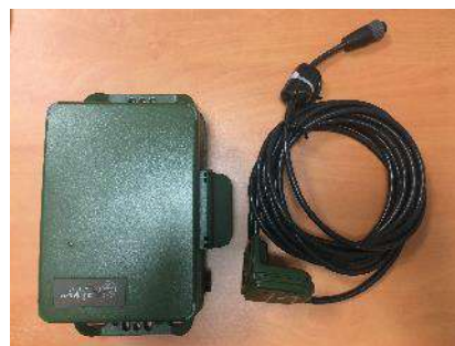
Illustration 14 : Enregistreur SM4Bat avec microphone U2
