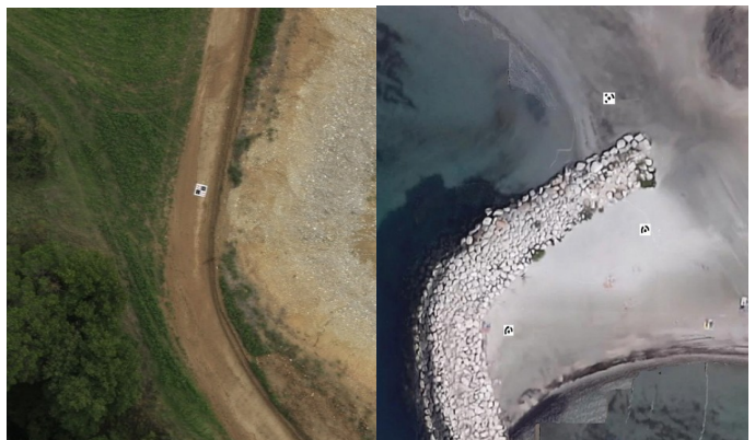
Figure 4 : Exemple d'implantation de cible géo-tagagée
