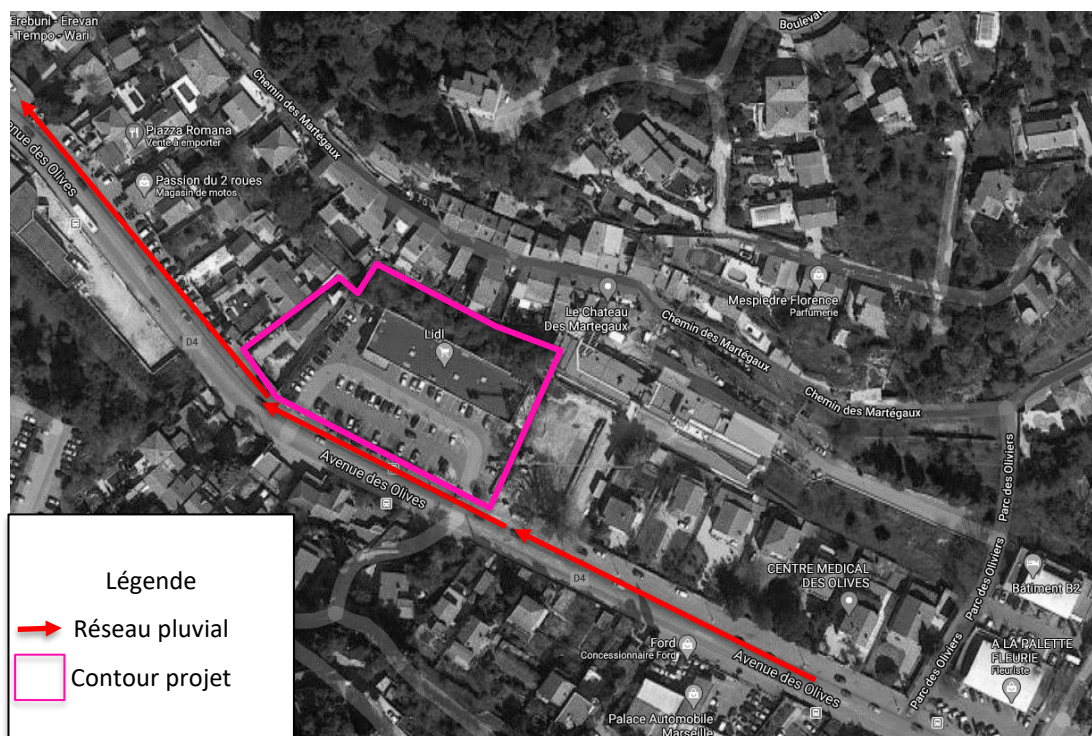
Illustration 4 : Réseau pluvial au droit du projet
