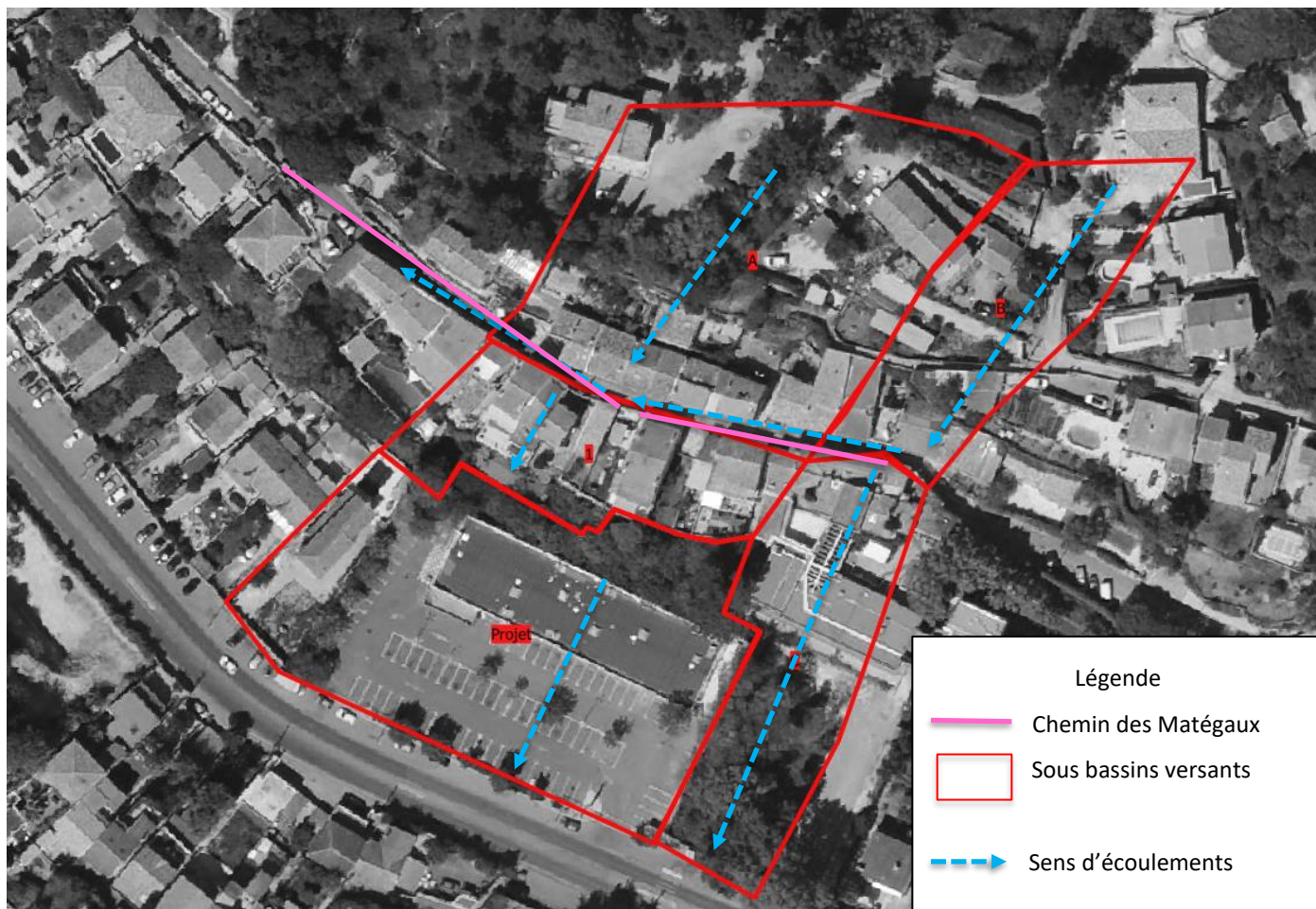
Illustration 5 : Délimitation des sous bassins versants de l'opération
