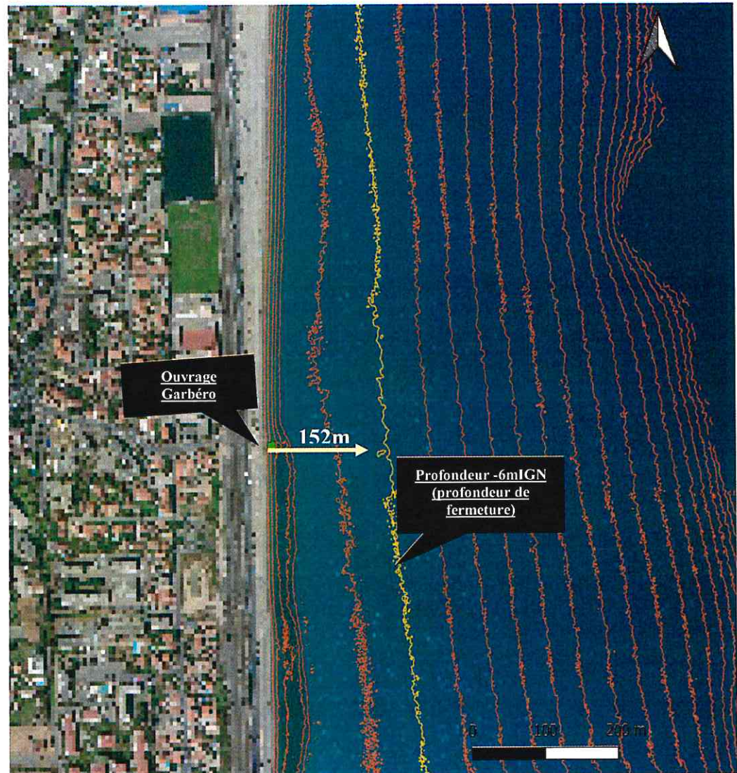
Figure 7. Localisation de la profondeur de fermeture au droit de l'ouvrage Garbéro, BDO Alpes-Maritimes 2015, Bathymétrie SHOM
