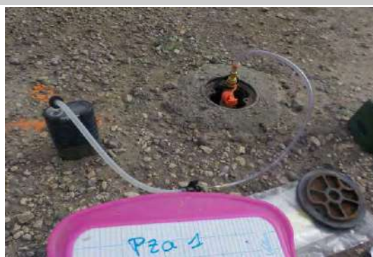
Vue générale du dispositif de prélèvement (point de prélèvement jusqu'à la pompe)
