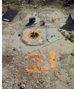
Vue générale du dispositif de prélèvement (point de prélèvement jusqu'à la pompe)
