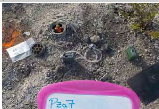
Vue générale du dispositif de prélèvement (point de prélèvement jusqu'à la pompe)
