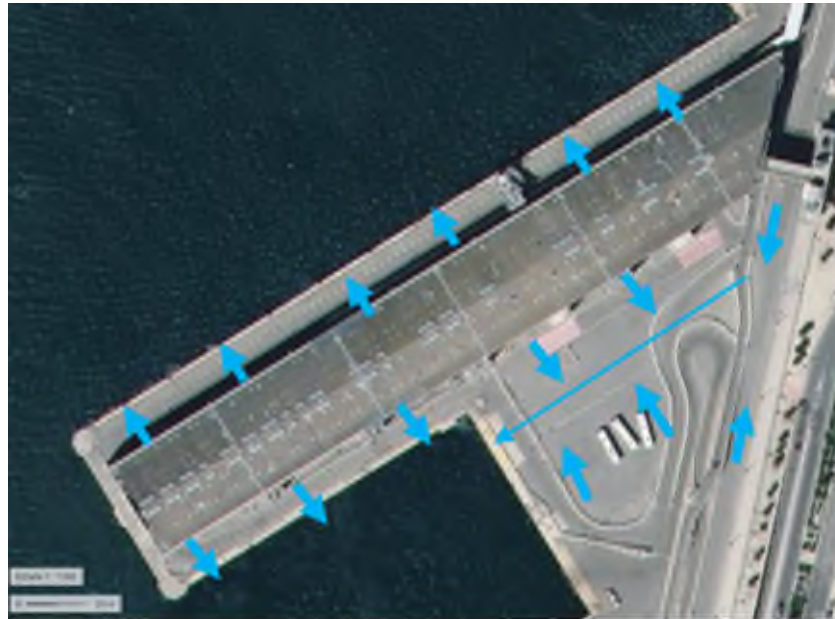
Figure 56 - Écoulement des eaux pluviales
