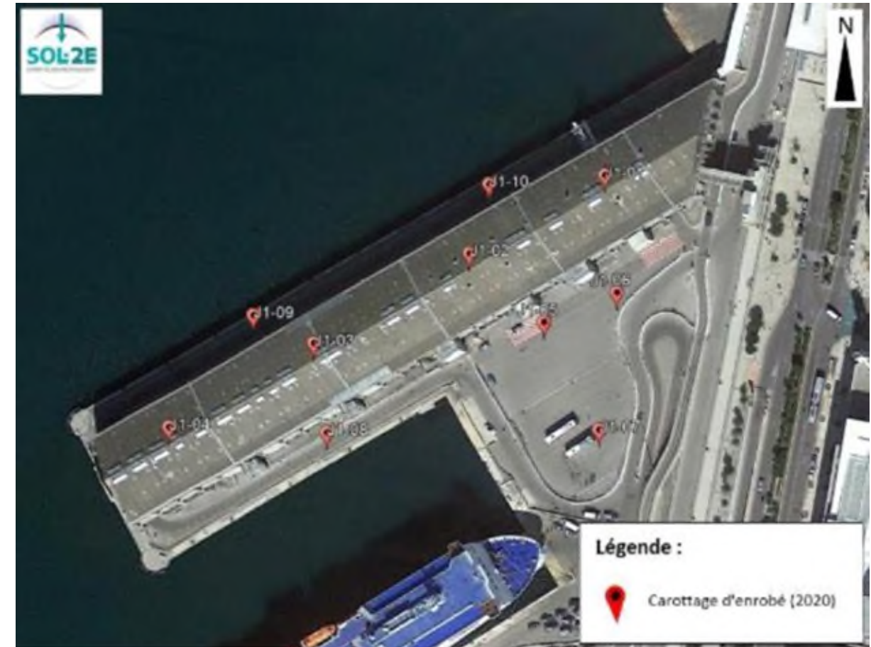
Figure 63 - Carottage des enrobés pour analyses d'amiante et HAP (SOL-2E)
