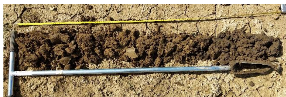
P8 – FLUVIOSOL-REDOXISOL cultivé au niveau d'une zone temporairement inondée au sein de la parcelle cultivée ouest
